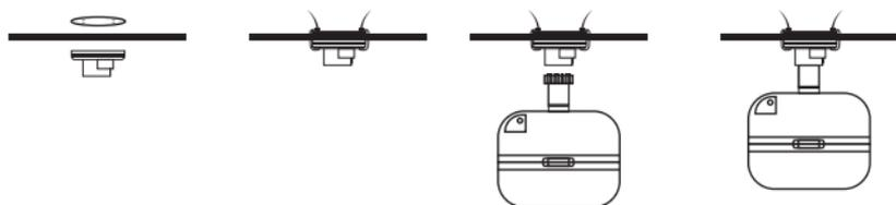
1. Připevněte kulatý držák na šrouby nebo vázaací pásy.
